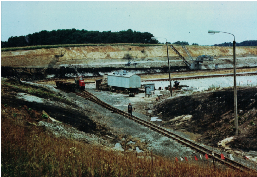
Abb. 12: Blick in die 1979 westlich des Pönitzer Weges erschlossene „Tongrube am ehemaligen Ratssteinbruch“ mit Grubenbahn und Gleisanschluss für den Tontransport zur Ziegelei. Im Hintergrund sichtbar die geologische Schichtenfolge mit liegenden Tertiärschichten (unten rechts: Bitterfelder Deckton, helle Schicht, darüber 3. Lausitzer Flöz, dunkles Band) und darüber befindlichen Moränen- und Schmelzwasserablagerungen der Tauchaer Endmoräne (bräunlich-gelbe Schichten), 1981. (Foto: O. Priese)
