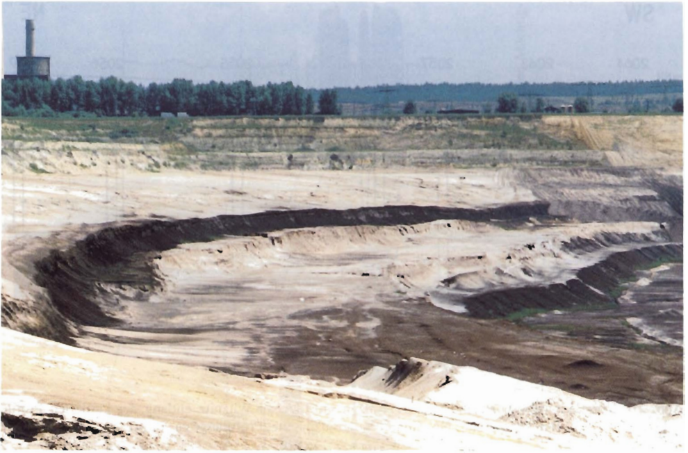
Foto 1. Die Hainer Sande im Tagebau Witznitz als Mittel zwischen den Flözen II/III und IV
