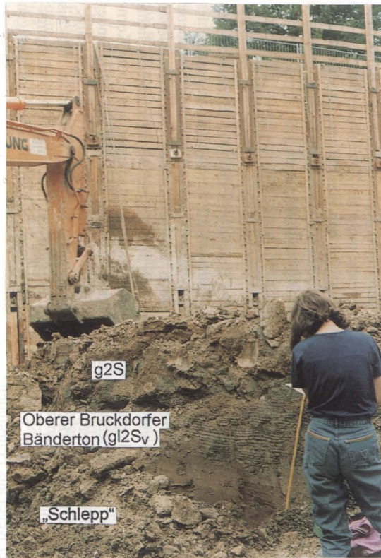
Bild 6. Auftreten des Oberen Bruckdorfer (Vorstoß-)Bändertons in Leipzig-Gohlis (temporärer Aufschluß Landsberger Straße 23). Deutlich erhöhte Lagenmächtigkeiten („Riesenwarven“) kennzeichnen den Liegendübergang des unter der zweiten Saalegrundmoräne lagernden Oberen Bruckdorfer (Vorstoß-)Bändertons.
