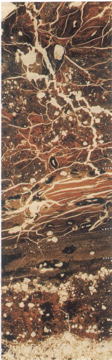
Bild 5. Dünnschliffbild des Oberen Bruckdorfer (Vorstoß-)Bänderton aus dem Tagebau Delitzsch-Südwest. Dargestellt ist der mikrotexturelle Aufbau des Liegend-Überganges des Stauseesedimentes: glazifluviale Sande – Stauseerandfazies („Schlepp“) – Bänderton im engeren Sinne.
