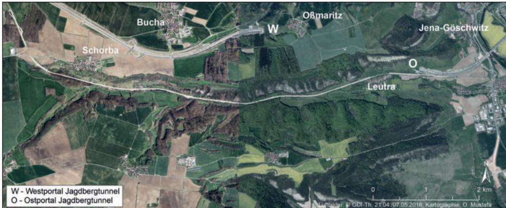
**Abb. 1:** Die Alttrasse (Bildmitte, helle Linie) durch das Leutratall fällt von den Höhen bei Schorba bis in die Aue bei Leutra auf einer Länge von knapp 9 km um mehr als 200 Höhenmeter ab. Aus 12 Luftbildern (Vermessungsamt) vom 21.04. (links) und 07.05.2016 (kartographiert von O. Mustafa, 2018).
