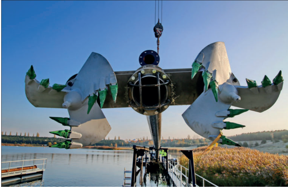
Abb. 9: Diese Schneidköpfe lockern das Sedimentmaterial in etwa 25 m Wassertiefe vom Seeboden. Dann wird der aufgelockerte Schluff mit den enthaltenen Bernsteinen nach oben gesaugt und durch die Rohrbrücke zur Arbeitsplattform mit der Aufbereitungsanlage transportiert (Foto: A. Wendel).
