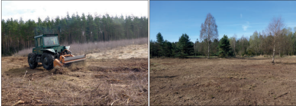
Abb. 17: Tiefmulchen mit dem Forstmulcher auf der Lehrgrenze. Das Mulchmaterial wurde anschließend von der Fläche verbracht und verwertet (Fotos: E. Endtmann).
