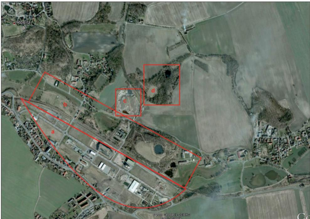
**Abb 1:** Überblick über das ehemalige Teerverarbeitungswerk und die Sandrube in Rositz a: Werkgelände; b: Schadstoffdeponie; c: Teersee „Neue Sorge“; d: aufgelassene Sandgrube Rositz /Fichtenhainichen.
