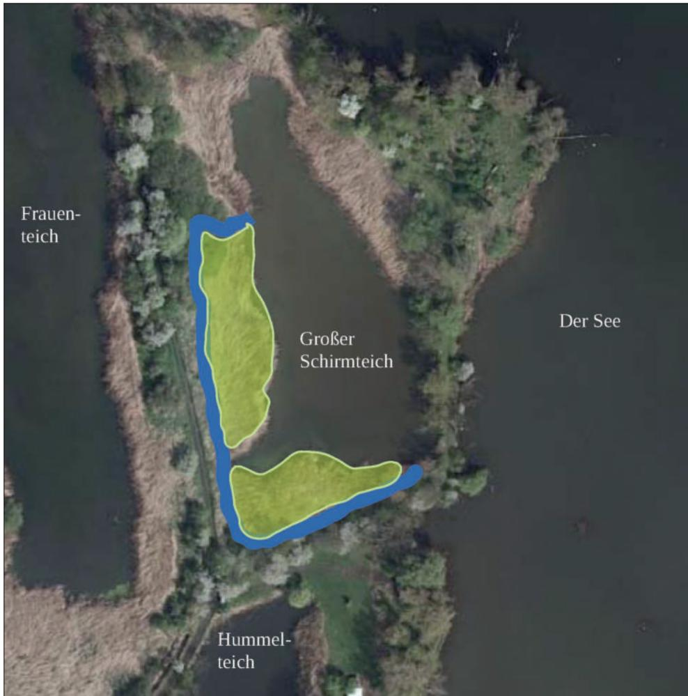
**Abb. 41:** Schaffung von Schilfinseln (grün) und fischfreien Flachwasserzonen (blau) am südwestlichen Uferbereich des Teiches durch Aushub und Teilberäumung von Ufer- und Verlandungszone..
