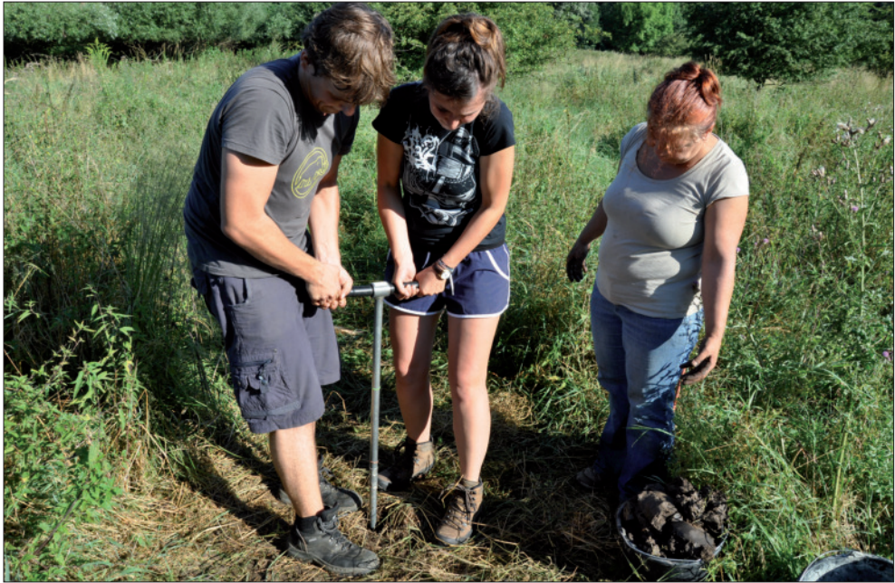
Abb. 9: Bohrarbeiten zur Ermittlung des Grundwasserflurabstandes mittels Edelmann-Bohrer der Firma Eijkelkamp (Foto: G. Baumkötter, 2013).
