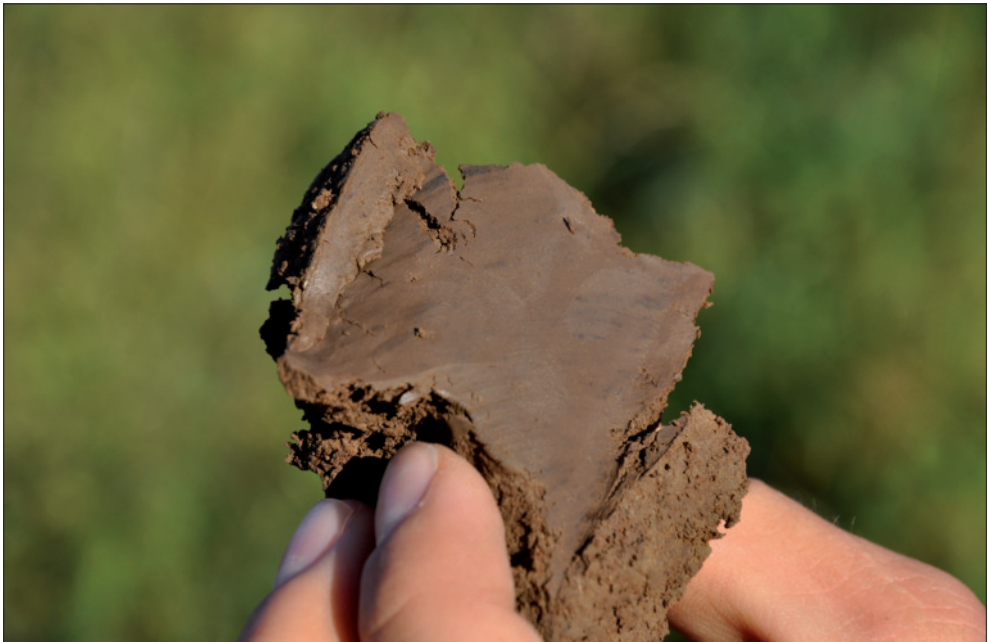
Abb. 10: Im Zuge der Bohrarbeiten erfolgte eine Bodenansprache, hier Auelehm mit hohem Schluffanteil (Foto: S. Krautz, 2013).
