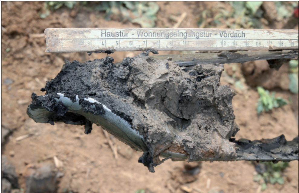
Abb. 35: Übergang von schwarzer Organomudde (Verlandungssediment eines Paläomäanders) zu grundwasserbeeinflusstem (grauem) Auelehm in der Bohrung GST 3/2013 ca. 1,85–1,95 m uGOK (Foto: E. Endtmann, April 2013).
