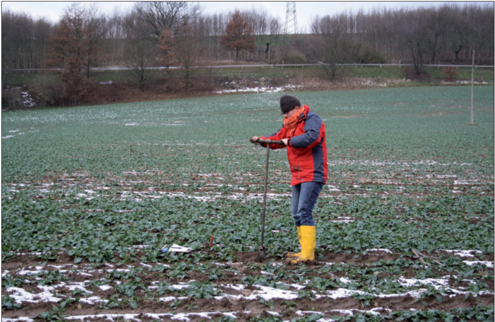
Abb. 33: Bohrarbeiten zur Erkundung eines historischen Sprottemäanders und Gewinnung von Bodenproben (Foto: U. Morgenstern, Dezember 2012).
