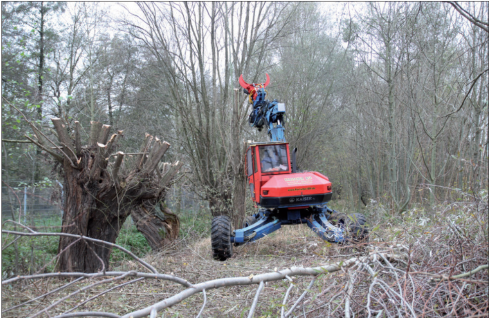
Abb. 39: Der Baumschnitt mittels Schneidgreifer ist an schwer zugänglichen Bereichen von Vorteil, erfordert aber ein manuelles Nachschneiden mit der Kettensäge (Foto: E. Endtmann, November 2012).
