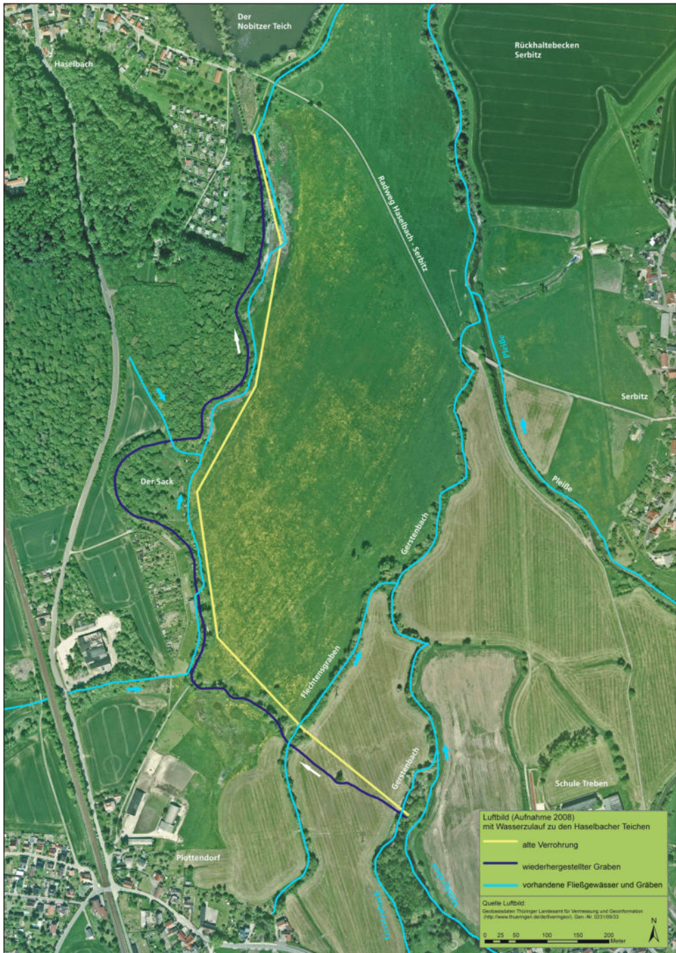
Abb. 19: Wasserzulauf zu den Haselbacher Teichen (gelb – Verrohrung, blau – wiederhergestellter historischer „Fischgraben“).
