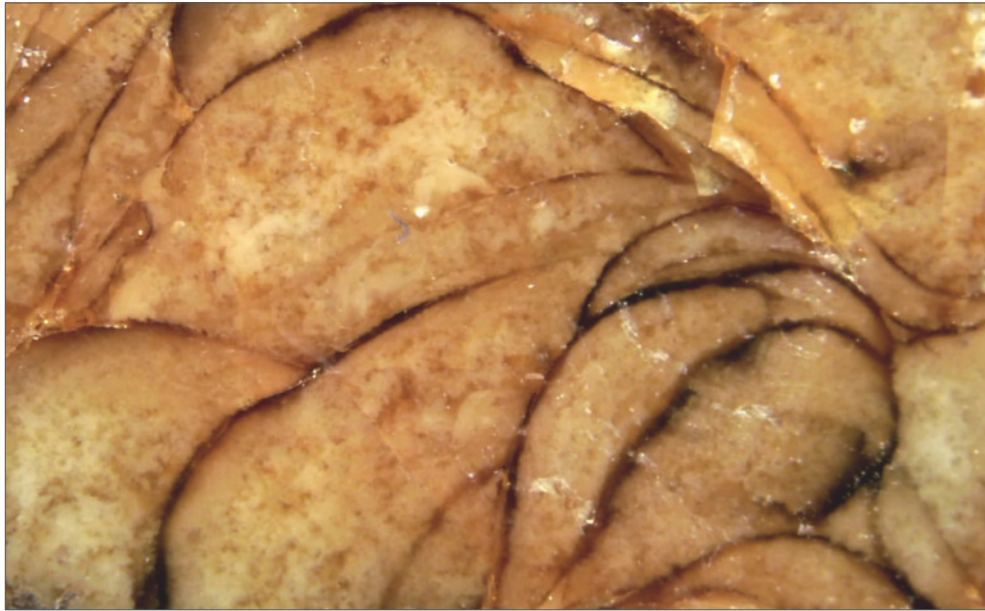
Abb. 9: Bitterfeldit (Bitterfeld) – Anschliff der Fließform mit Feinstruktur der Einsprenglinge, Bildbreite 18 mm.
