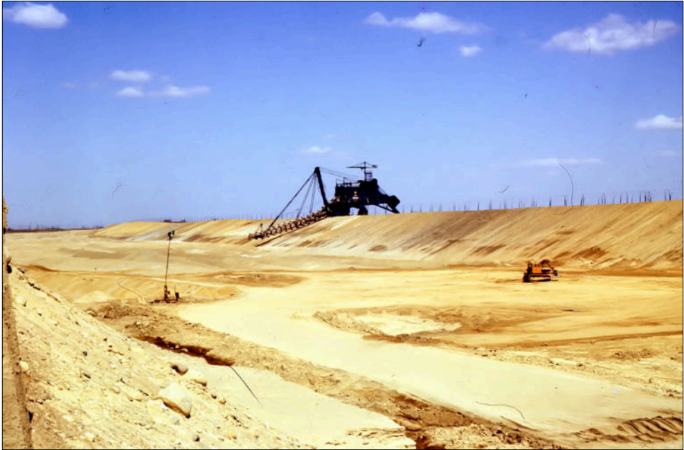
Abb. 4: Der alte Eimerkettenbagger 549, ein einst technisches Denkmal im ersten Abraumschnitt im Tagebau Breitenfeld im Mai 1983 bei der Anlage der Aufschlussfigur.
