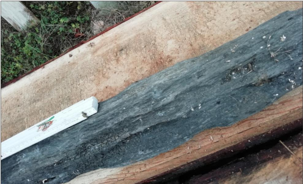
**Abb. 10:** Fluviale Erosionsspuren durch Sedimenttransporte an einem Mooreichenast (Foto R. Zenger).
