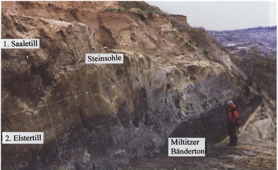
Bild 4. Eine Quartärfolge im Hangenden des Miltitzer Bändertones, Profil 6 südlich von Güldengossa (Tagebau Espenhain)
