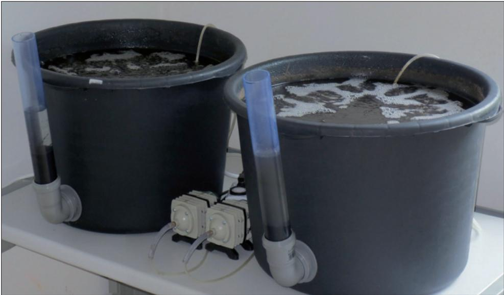
**Abb. 1:** 60-Liter-Mörtelkübel mit Schlammfüllung und Sichtrohr für Belüftungsversuche 24 h/d (links) u. 12 h/d (rechts; Foto: A. Borowski).
